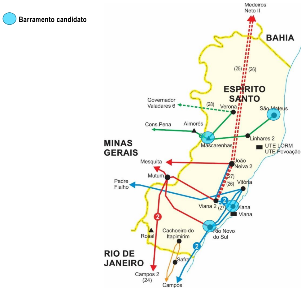
Figura 9-9: Sistema elétrico no estado do Espírito Santo
